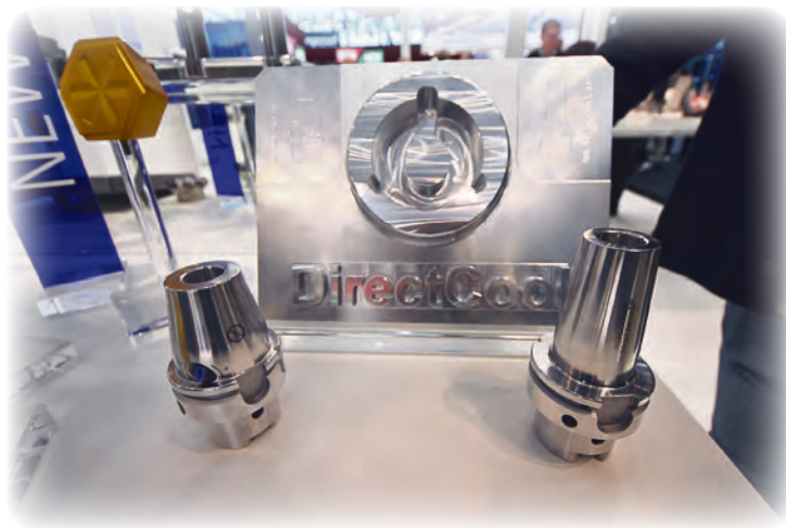
UNIQ-Dream-Chuck med DirectCool: Det nya DirectCool-tillvalet möjliggör exakt decentraliserad kylning längs verktygsskaftet till skäreppen med tre kylkanaler.
