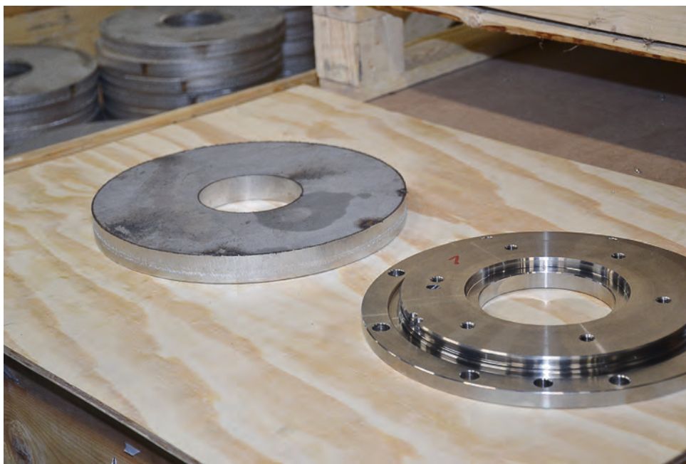
Detalj - före och efter bearbetning i den nya fleroptionsvarven CLX 550 TC.
