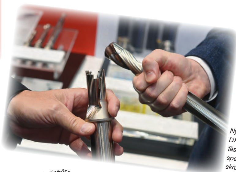
Neo-Mill-16-Finish: Ny planfräs för finfräsning i stål och gjutgods med ställbara wiperskär + vändskär med 16 skäreppor.
